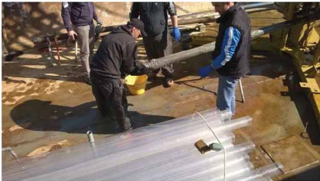
Foto n. 5: Fase di estrazione del liner trasparente dal vibrocarotiere a bordo del Motopontone VIGLIENA – PC 1177
