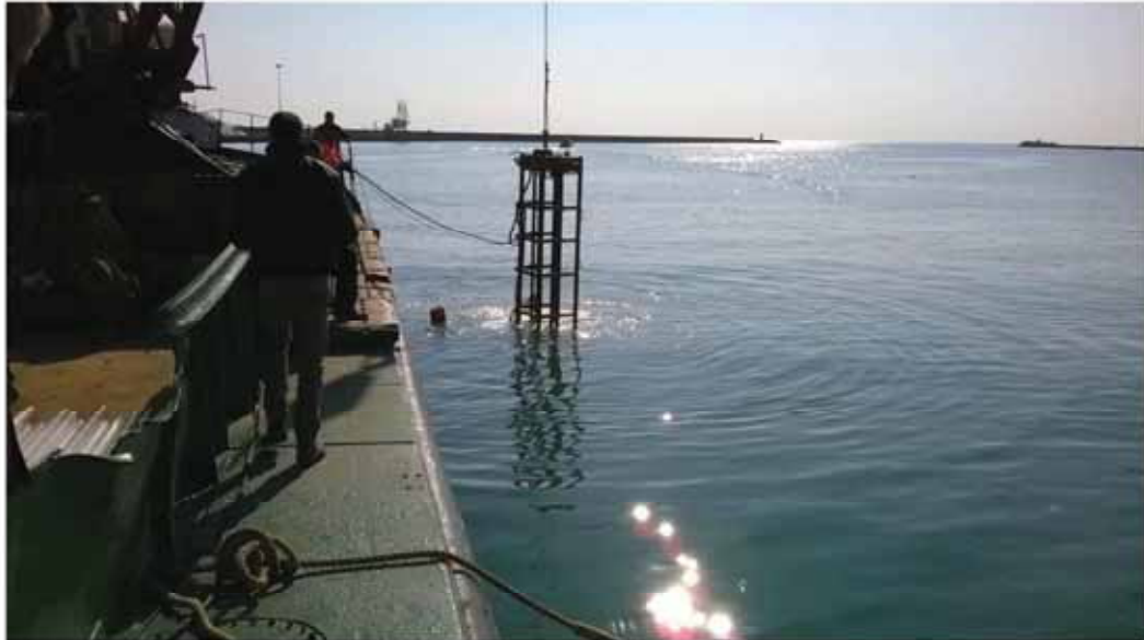
Foto n. 4: Fase di prelievo della carota con immersione del vibrocarotiere, sul punto prestabilito ed indicato sul campo dalla boa di segnalazione precedentemente posizionata
