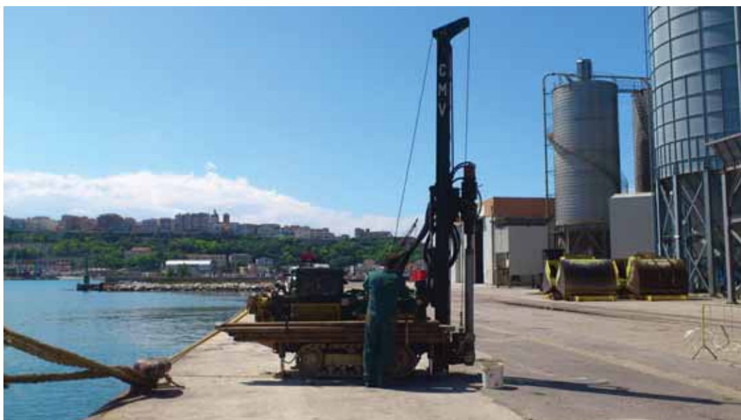
Foto 04 - Carotaggio a distruzione di nucleo sulla banchina per individuazione del piano di fondazione della banchina Nord.
