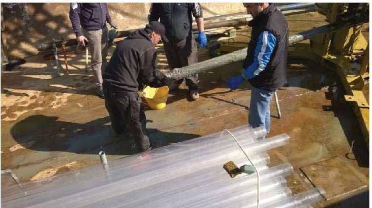
Foto n. 5: Fase di estrazione del liner trasparente dal vibrocarotiere a bordo del Motopontone VIGLIENA – PC 1177
