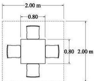
Area occorrente per il posizionamento di un tavolo quadrato di m. 0.80 x 0.80 e relative quattro sedie m. 2.00 x 2.00
