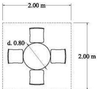
Area occorrente per il posizionamento di un tavolo rotondo di m. 0.80 di diametro e relative quattro sedie m. 2.00 x 2.00
